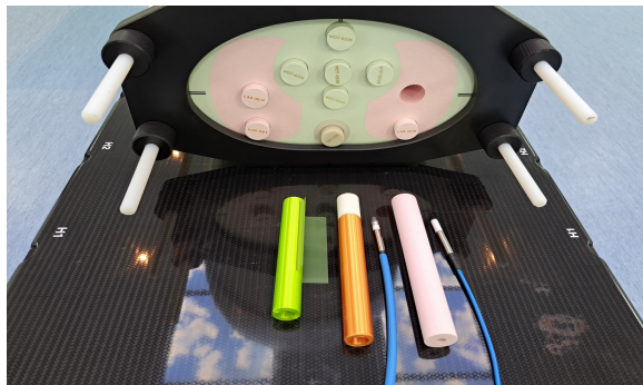
Figura 2. Vista frontal del fantoma CIRS de pulmón y los insertos. El inserto rosado es original del fantoma y puede alojar una cámara pinpoint o un diodo. El inserto de color naranja se imprimió con PLA y puede alojar en su interior una cámara pinpoint o un diodo. El inserto color verde sirve para colocar pequeñas placas radiocrómicas.
